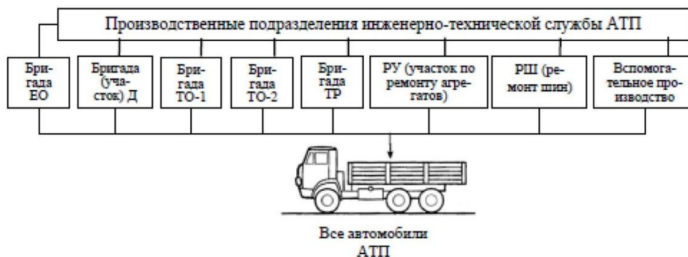
Рисунок 1 - ОПС при организации по методу специализированных бригад Организация производства ТО и ТР автомобилей по методу
